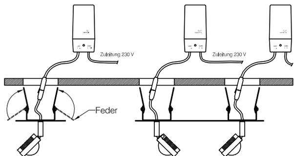
① Für den Deckeneinbau benötigen Sie einen Lochdurchmesser von 68mm und einer Deckenstärke von max. 20mm. Bei sehr dünnen Blechstärken besteht die Gefahr daß die Blechdecke durch die starke Federkraft beschädigt wird.
